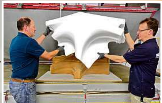
Frank Birkner (50, l.) und Jens Oehme (45) heben ein Fassaden-Element aus der Vakuumpresse, in der es bei 160 Grad geformt wurde.
