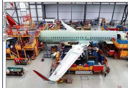
Endmontage eines A320 im Airbus-Werk in Finkenwerder.
