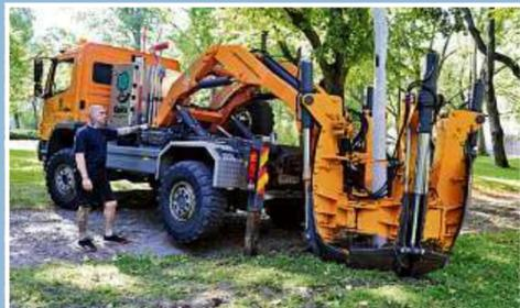
Maschinenführer Gerhard Urban (48) lässt die Schaufeln mit einem Druck von bis zu 15 Tonnen ins Erdreich gleiten und hebt gleichzeitig die neue Grube für den Baum aus.
