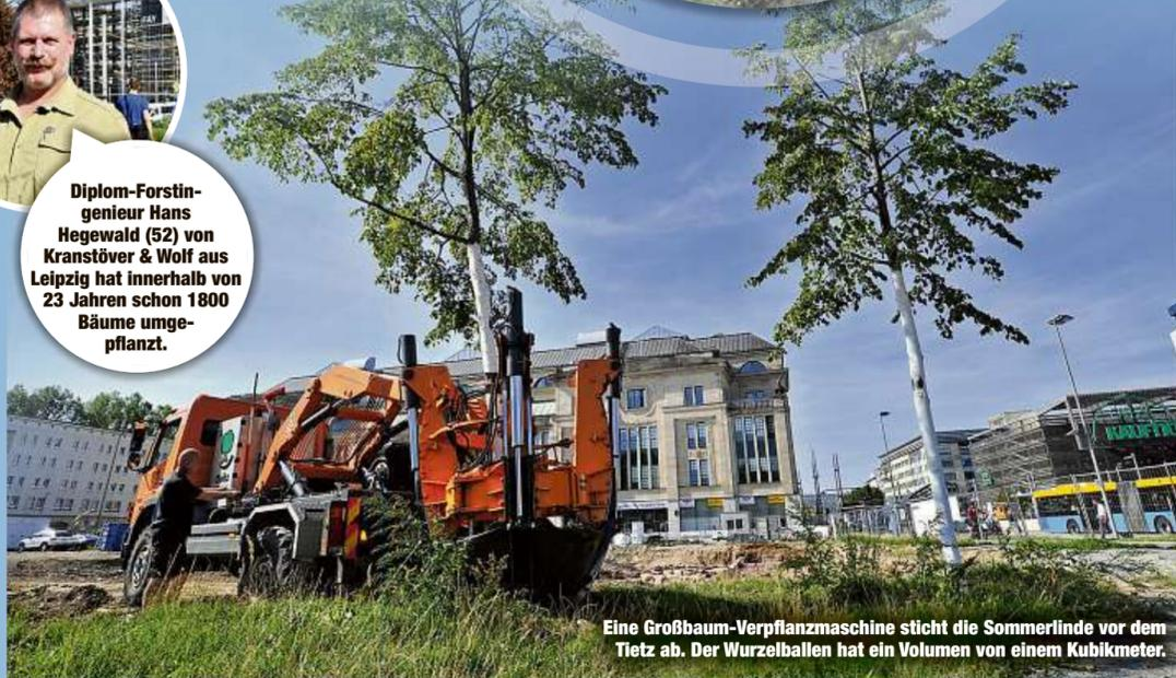
Eine Großbaum-Verpflanzmaschine sticht die Sommerlinde vor dem Tietz ab. Der Wurzelballen hat ein Volumen von einem Kubikmeter.
