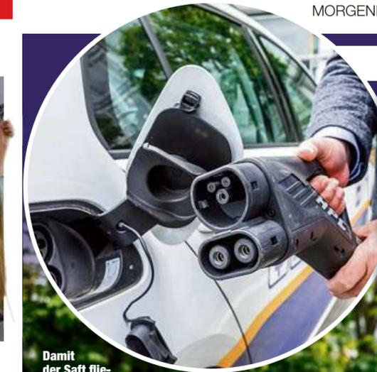
Damit der Saft fließen kann: Der 150 kW-Gleichspannungsladepunkt wird via Ladekabel und -stecker mit dem Fahrzeug verbunden.
