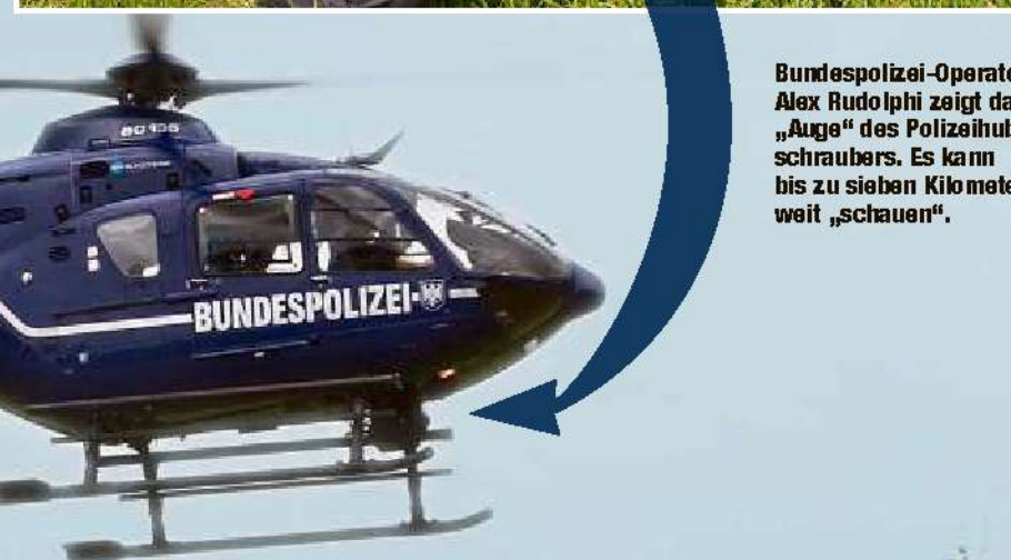
Ein Eurocopter EC 135 der Bundespolizei startet. Unterhalb der Zelle sind die Kameras befestigt. In der Dunkelheit fliegen die Piloten mit Nachtsichtgeräten.
