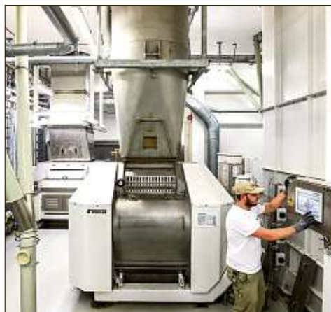
Ein Müller überwacht ein Flockierwalzwerk zur Herstellung von Haferflocken.
