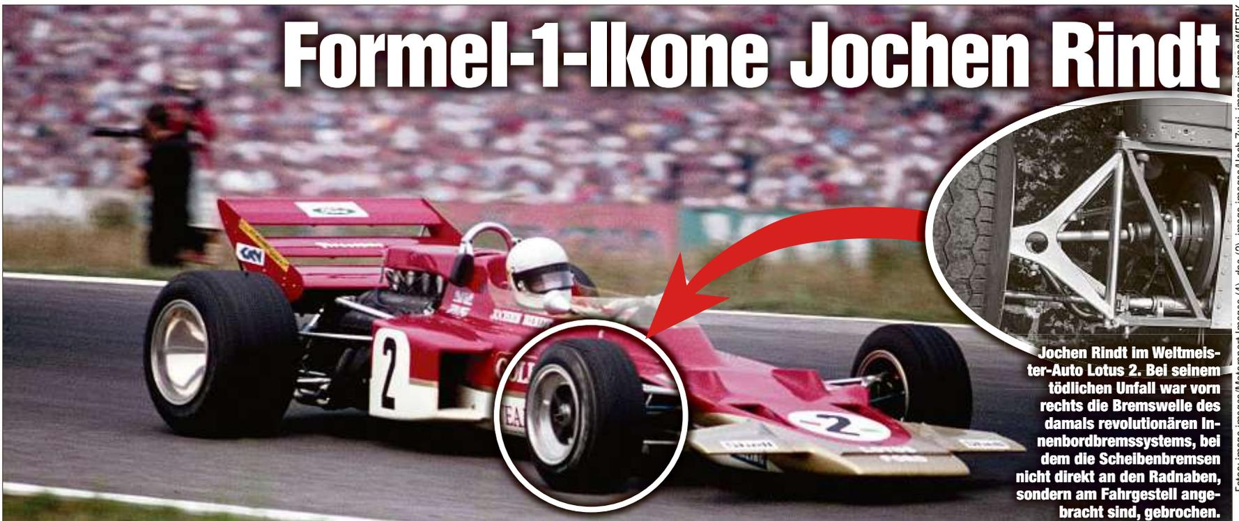
**Jochen Rindt im Weltmeister-Auto Lotus 2. Bei seinem tödlichen Unfall war vorn rechts die Bremswelle des damals revolutionären Innenbordbremsystems, bei dem die Scheibenbremsen nicht direkt an den Radnaben, sondern am Fahrgestell angebracht sind, gebrochen.**
